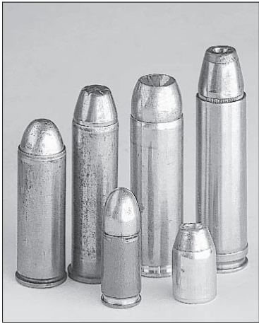
Patronen, von links: .454 Casull, .445 SuperMag., .500 S&W, .460 GJW. Davor ein 460er-Geschoss und eine Patrone 9 Para als Vergleich.
